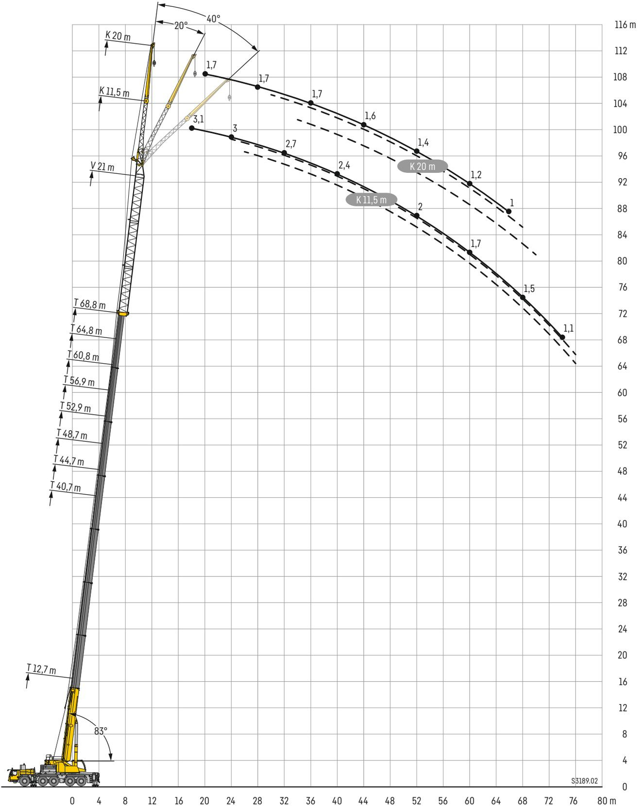
Lifting capacities • Forces de levage • Portate • Tablas de carga • Грузоподъемность
